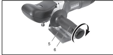
Установите защитную скобу (5) на резьбовой элемент на дополнительной рукоятке (6). Выровняйте скобу и закрепите с помощью дополнительной рукоятки.
