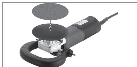
**!** Используйте только те зажимные гайки, которые поставляются в комплекте с опорной тарелкой!
