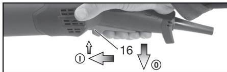
**Включение:** передвиньте вперед нажимной переключатель (16), затем нажимной нажмите вверх переключатель (16).
