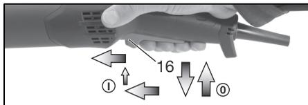
**Включение:** включите инструмент, как описано выше. Нажимной переключатель (16) передвиньте вперед еще на одну позицию и отпустите в этом положении, чтобы зафиксировать нажимной переключатель (16) (непрерывный режим работы).
